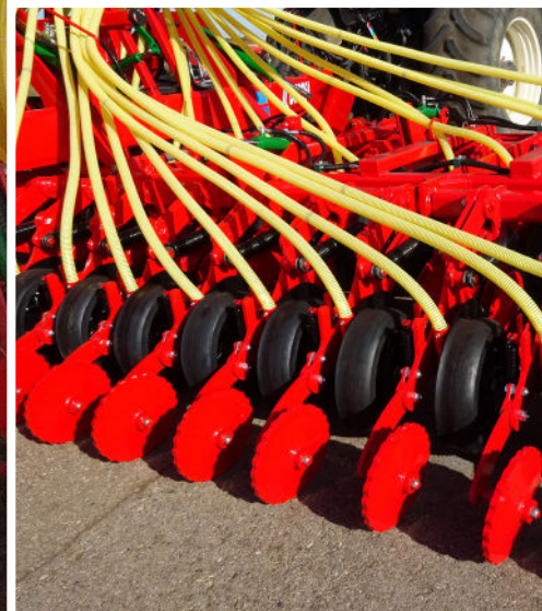
Ruedas onduladas "aprieta semilla" que dejan un surco para facilitar la siembra segura.
