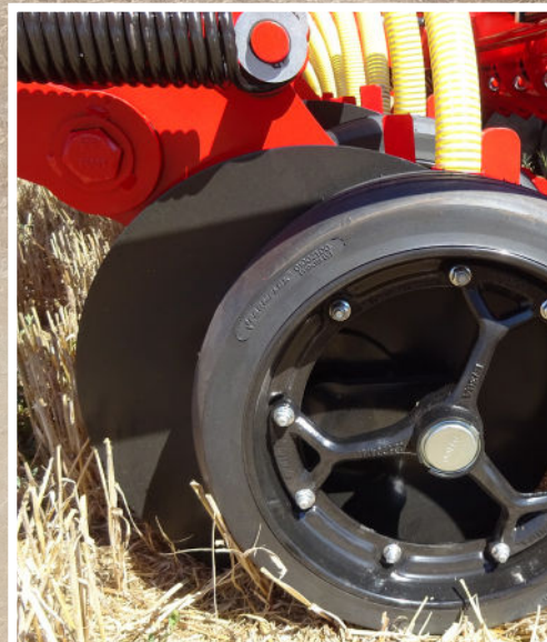
Ruedas de radios, que permite situaciones de mucha humedad.
