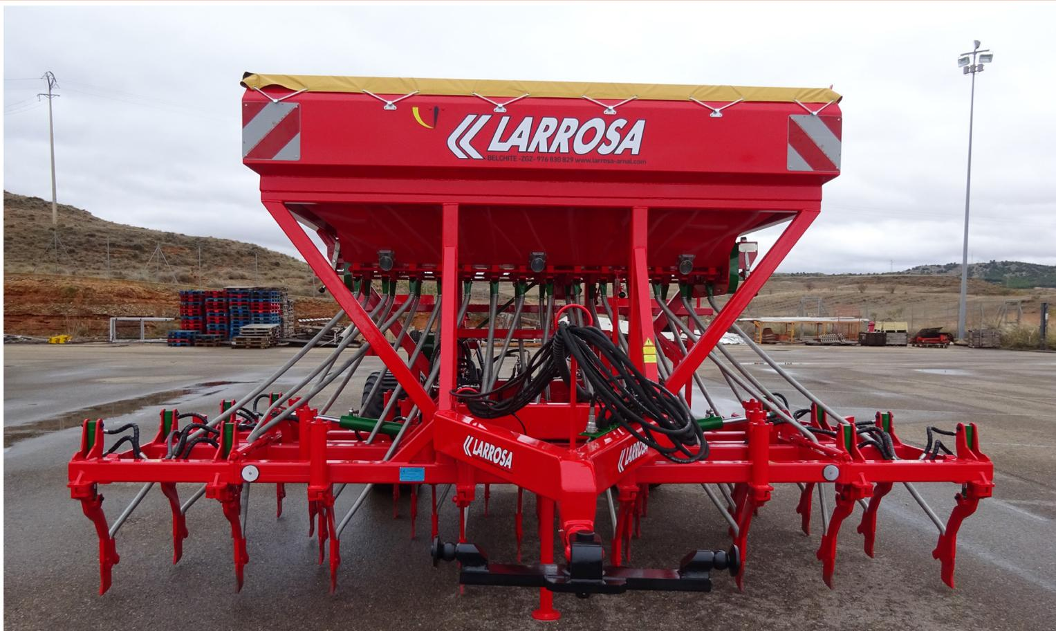
El **enganche al alzamiento del tractor** nos permite tener el control de profundidad de las rejas en todo momento, con una gran capacidad de giro, pudiendo memorizar el punto de bajada en el mando del tractor.
