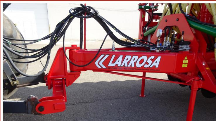
Enganche articulado a los dos puntos del tractor, muy robusto y que permiten una gran maniobrabilidad
